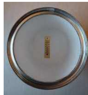
Contenitore acciaio con FREDDO STOP (Una prima mano di fissativo KALORFIX e 3 mani di FREDDO STOP)
