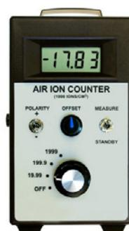
Con questo strumento portatile *MTT Italia* ha la possibilità di misurare la quantità di ioni negativi per  $\text{cm}^3$  all'interno delle abitazioni prima e dopo l'applicazione di *Ülkerfarbe Biotech*.
